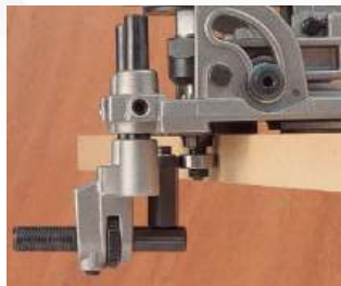
Esquadro lateral, evita a cópia das irregularidades dos cantos
