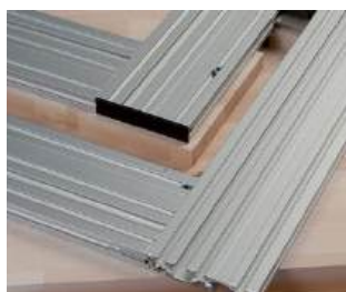
Equipada com acessório para encaixes rectos (sem raio), evitando enchimento posterior com betume.
