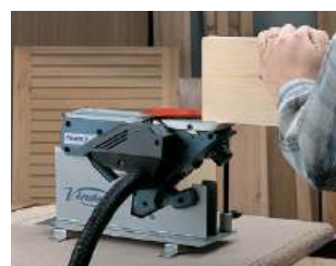
Suporte para uso da plana como máquina estacionária.
