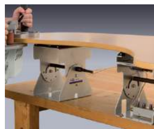
Fixação de uma peça de grandes dimensões com uma unidade auxiliar SVN470.
