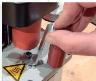
Rolo auxiliar para orlagens a 90°. É possível colocá-lo em 2 posições diferentes, conforme a peça a ser orlada.
