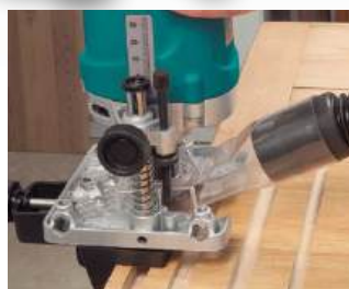
Fresado de ranhuras em madeira ou materiais plásticos
