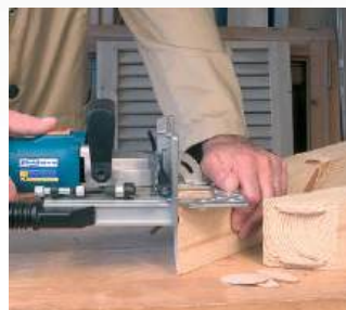
Uniões fortes com lamelas No. 6.
