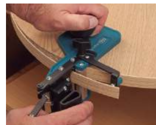
Corte da orla sobrando em painéis redondos
