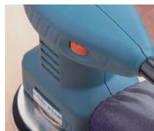
Regulação electrónica da velocidade
