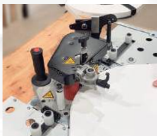
Orlagem de painéis retos, com formas ou biselados (até 45°).
