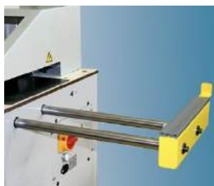
Guia extensível para peças compridas.
