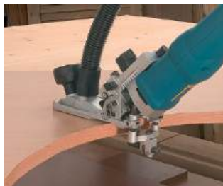
Copiador com rolamento. Guia perfeita em superfícies curvas ou rectas
