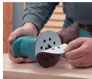
Furos de aspiração desenhados para discos normalizados.
