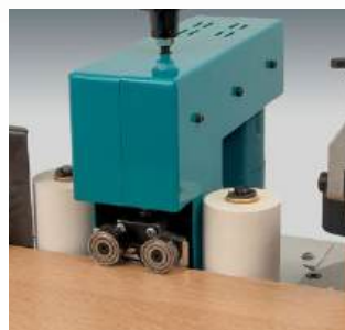
Inclui um perfilador para o acabamento do excedente em orlas de até 1 mm de espessura.
