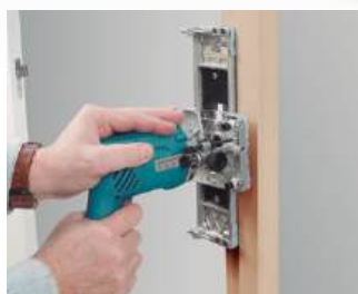
A sua regulação milimétrica permite a fresagem de caixas para dobradiças.
