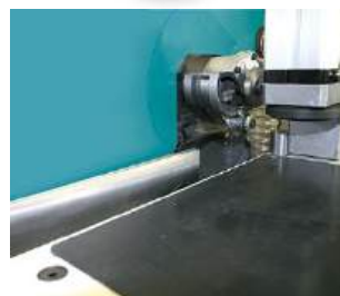
Esquadro e apoio do painel com precisão.
