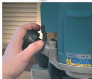
Interruptor e bloqueio do cabeçal a partir do punho para maior controle e segurança.
