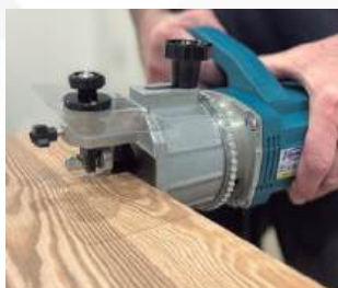
Corte de fôrmicas.
