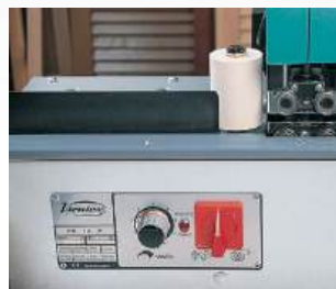
Regulação electrónica da temperatura.
