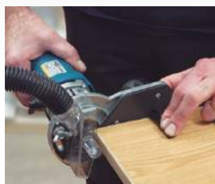
Preparação fácil para o perfilado das esquinas.
