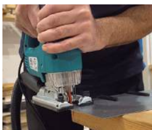
Corte de chapa metálica.
