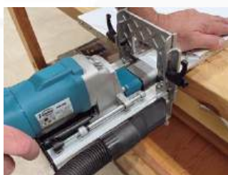
Perfuração fácil e rápida na borda do painel, a 90° e 45°.
