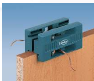
Perfilagem simultânea de ambas as faces.
