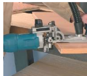
Perfilagem com fresa recta
