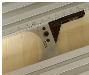
Equipada com acessório para encaixes rectos (sem raio), evitando enchimento posterior com betume.
