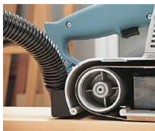
Ligação de aspiração externa no modelo LB31E.
