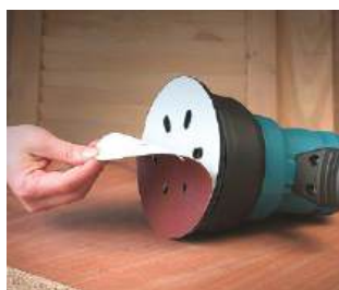
Orifícios de aspiração adaptados a abrasivos normalizados.
