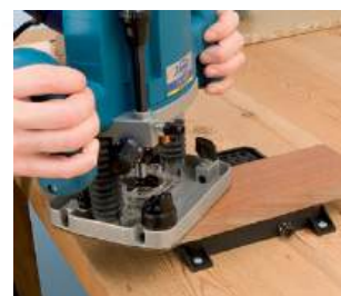
Fixação de pequenas peças numa parte dividida da placa de sucção.
