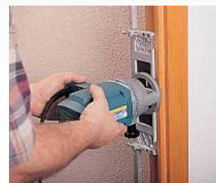
Colocação de dobradiças com o cabeçal CPN66.
