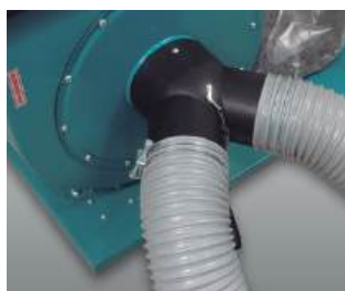
Com duas entradas de sucção, inclui 2 bocais de Ø 100 mm de origem
