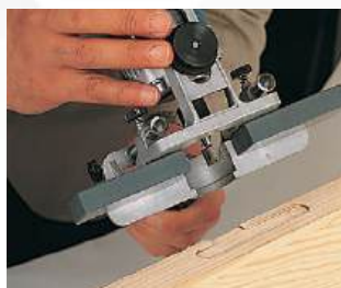
Colocação de dobradiças com o cabeçal ZB93.
