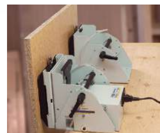
Trabalho em peças grandes com a ajuda de uma unidade auxiliar SVE680.
