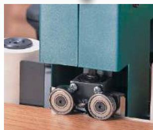
Perfilador motorizado: Corte da orla em ambas as faces simultaneamente.
