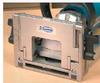
Frontal com topos em borracha anti-deslizantes, para melhor fixação e protecção
