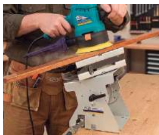
Modelo SVN460 com suporte dobrável y giratório regulável.
