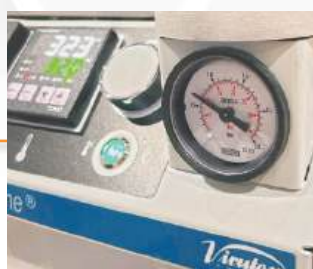
Pressão do ar comprimido autorregulada.
