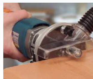
Cabeçote redondo V3 para perfilagem com apoio sobre a borda.
