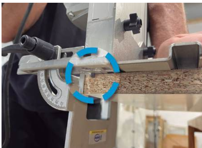
Sistema de posicionamento automático de batentes retráteis.
