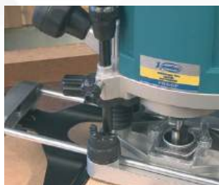
Afinação de profundidade em 6 posições.
