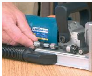
Afinação rápida das diferentes profundidades.
