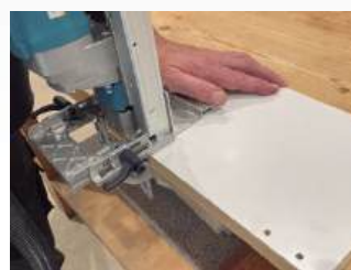
Perfuração fácil e rápida na borda do painel, a 90° e 45°.
