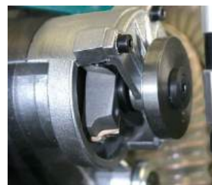
Copiador hidráulico independente da fresa.
