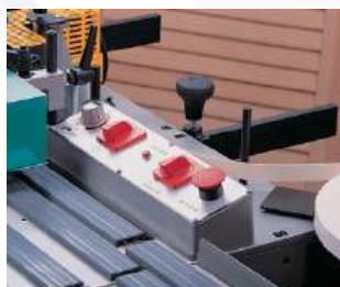
Segurança (STOP). Controle electrónico da temperatura.
