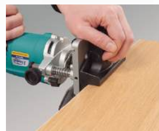
Perfilado de orlas em peças orladas.
