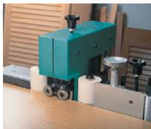
Perfilador motorizado em ambas as faces simultaneamente.
