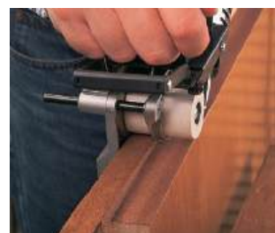
Orlando a parte superior do rebaiço.
