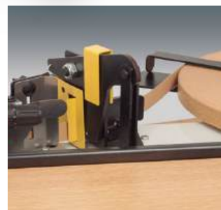
Corte traseiro da orla automático. Inclui pedal para peças redondas ou com formas.
