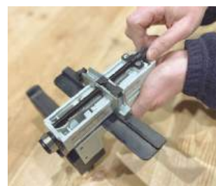
Ajuste micrométrico da largura de corte.
